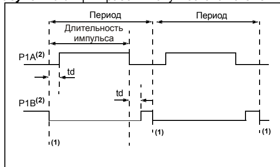
Рисунок 16-6. Цикл работы полу-мостовой схеме ШИМ
